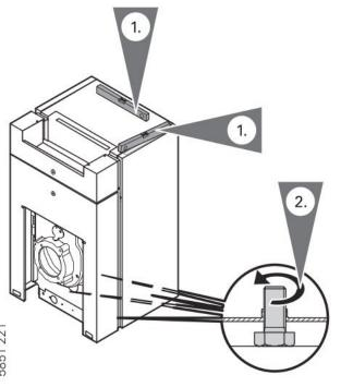
Heizkessel mit geringer Steigung nach hinten mit Stellschrauben bzw. Stellfüßen ausrichten. Besonderes Fundament ist nicht erforderlich.
