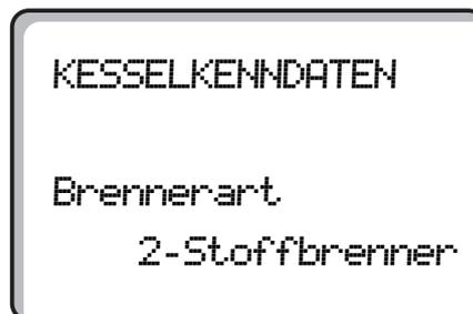
Funktion zur Umschaltung der Regelung zwischen Öl- und Gasbetrieb über den ES-Eingang (ZM432).
