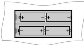
Zur Beleuchtung des Displays mitgelieferte Batterien (MICRO/ LR03/AAA) in Batteriefach auf der Gehäuserückseite einlegen.
