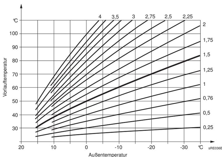
**Beispiel:** Die Steilheit der Heizkennlinie ist auf „1,5“ eingestellt. Außentemperatur beträgt 0°C:
