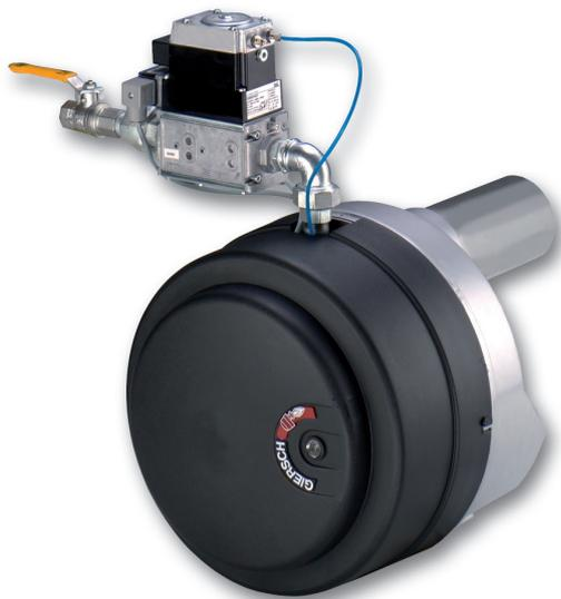
Vollautomatischer Gasbrenner geprüft und zugelassen nach DIN EN 676 geeignet zur Verbrennung von Erdgas (-N) und Flüssiggas (-F) gemäß DVGW G 260 mit elektromotorisch gesteuertem Luftabschluss (Ausführung -L) und schadstoffarmer Verbrennung (Ausführung -LN).
