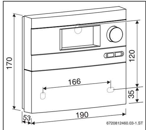
Bild 4 Abmessungen Gehäuse
