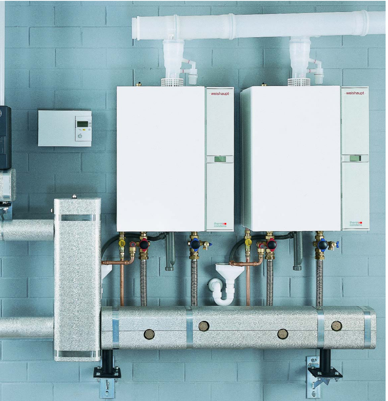
Bei einer Thermo Condens Kaskade mit 240 kW beginnt die Modulations-Mindestleistung bei 5%, sie wird bedarfsabhängig stufenlos bis zur Gesamtleistung erhöht
