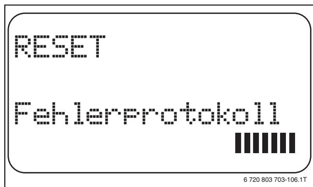
Bild 87 Fehlerprotokoll zurücksetzen
