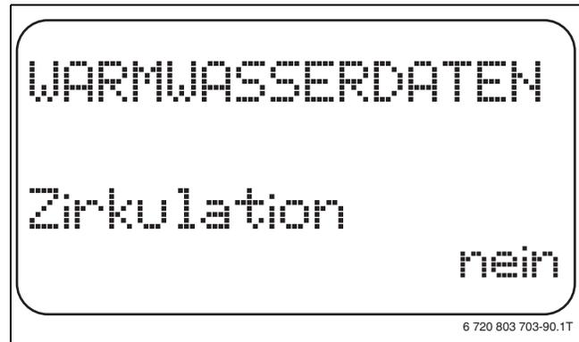
Bild 70 Zirkulationspumpe wählen
