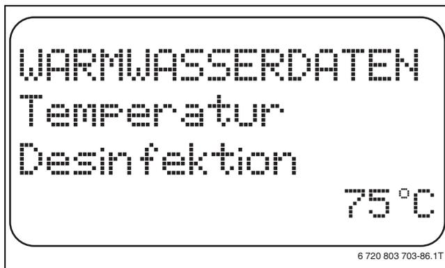
Bild 66 Desinfektionstemperatur einstellen
