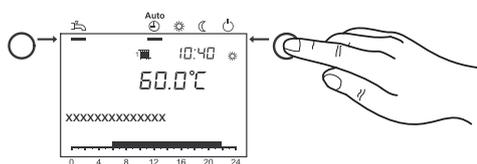
Mit der **Betriebsarttaste Heizbetrieb** wird zwischen den Betriebsarten für den Heizbetrieb gewechselt. Die gewählte Einstellung wird durch einen Balken unterhalb des Betriebsart-Symbols gekennzeichnet.
