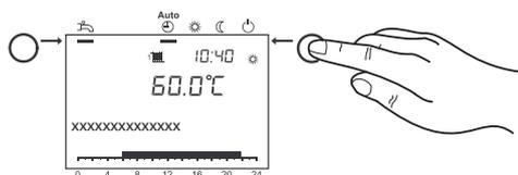
6. Durch Drücken der **Betriebsarttaste Heizbetrieb** die Programmierung verlassen.
