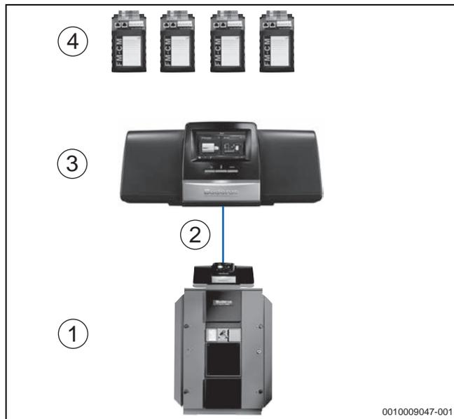
Bild 36 Regelgerät Logamatic 5311 für Heizkessel mit Anbaubrenner
