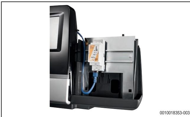
Bild 93 Montage von Bauteilen auf Hutschiene Modul
