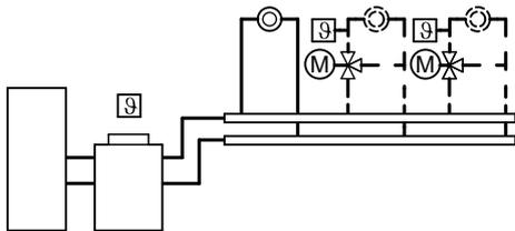
Witterungsgeführte, digitale Kessel- und Heizkreisregelung:
