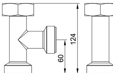
Die Erweiterung Wandanbau wird nur bei Vitoladens 300-T verwendet. Bei Vitoladens 300-C befindet sich der seitliche Anschluss bereits im Kleinverteiler am Heizkessel.
