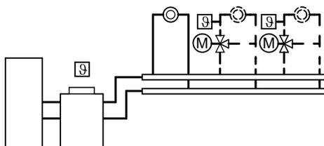
Witterungsgeführte, digitale Kessel- und Heizkreisregelung:
