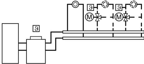
Witterungsgeführte, digitale Kessel- und Heizkreisregelung:
