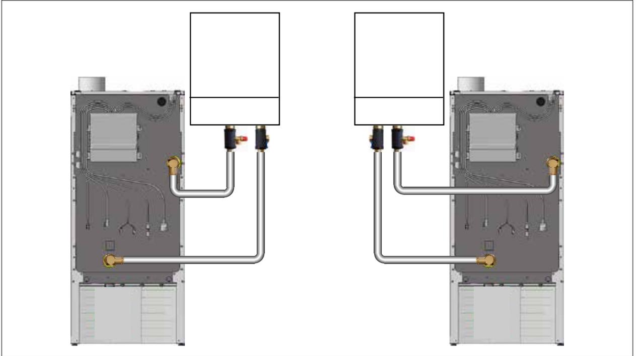
Abb. 5.7 Anschlussset neben Wärmeerzeuger an der Wand
