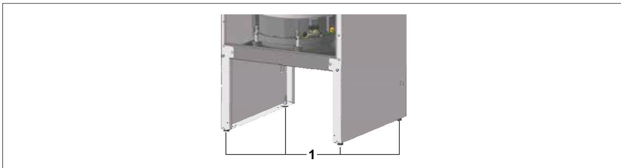
Abb. 5.4 Wärmerezeuger waagrecht ausrichten
