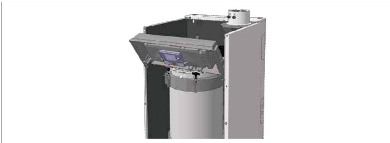
Abb. 6.5 Regelungskasten herunterklappen
