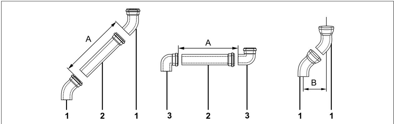
**Abb. 5.15 Länge Luft-/Abgasrohr**
