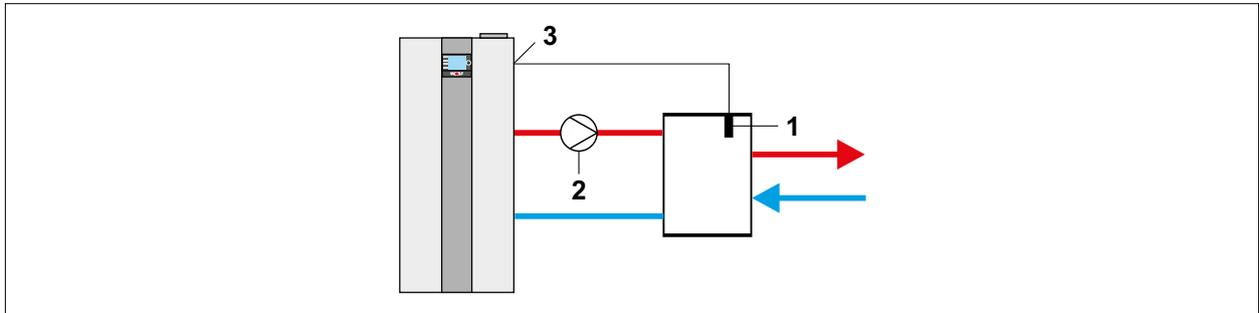
**Abb. 12.6 Anlagenkonfiguration 11 - Hydraulische Weiche / Plattenwärmetauscher als Systemtrennung**
