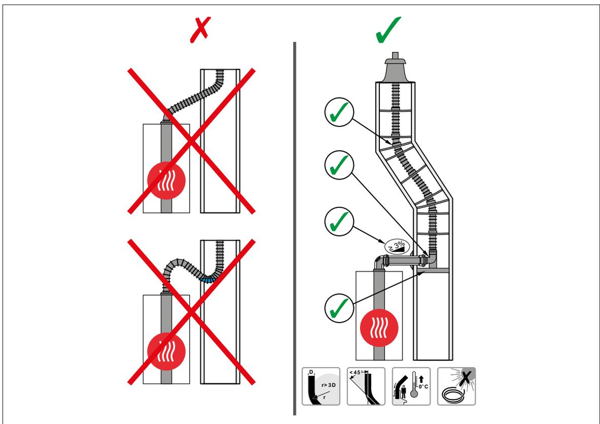
Abb. 5.14 Flexible Abgasrohre
