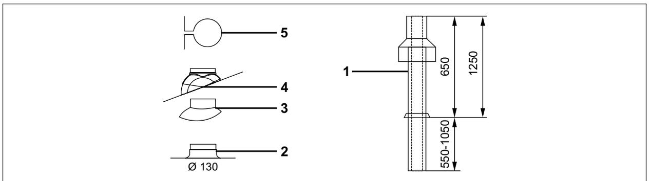
Abb. 5.17 Dachdurchführung [mm]
