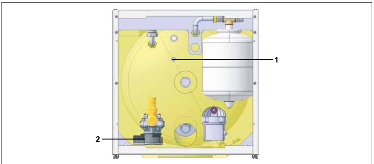
**Abb. 5.23 Elektroanschluss am Rohrwendelspeicher TR**
