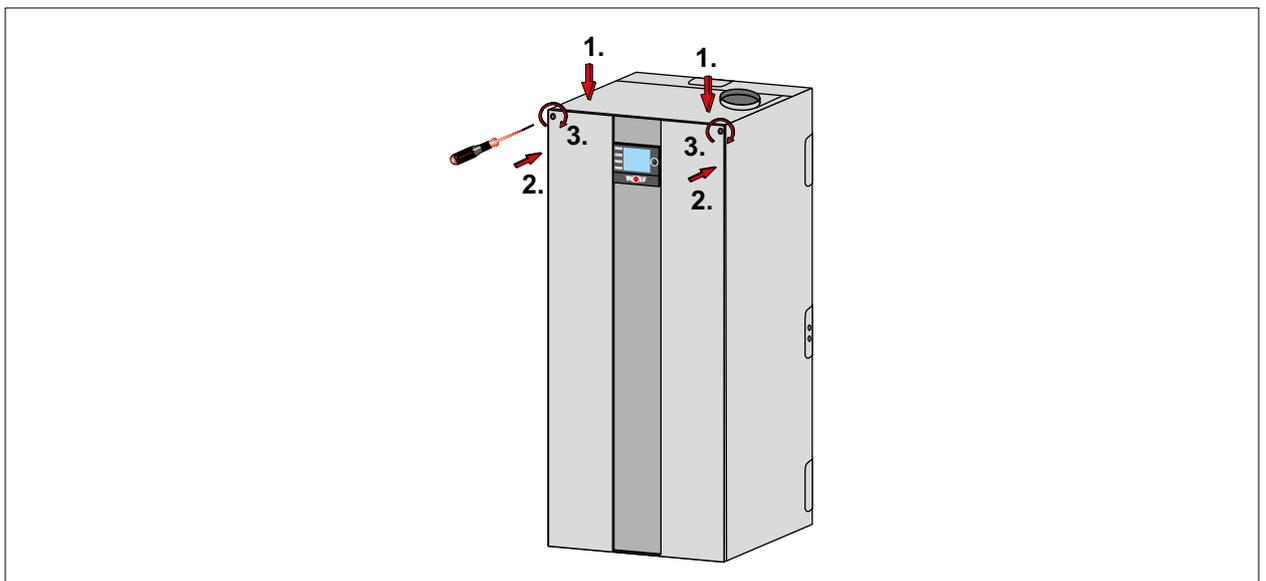
Abb. 5.3 Verkleidung montieren
