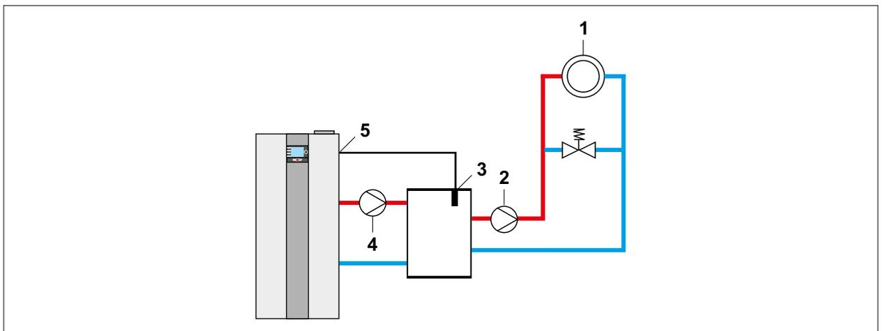
**Abb. 12.9 Anlagenkonfiguration 12 - Hydraulische Weiche mit Sammlerfühler**
