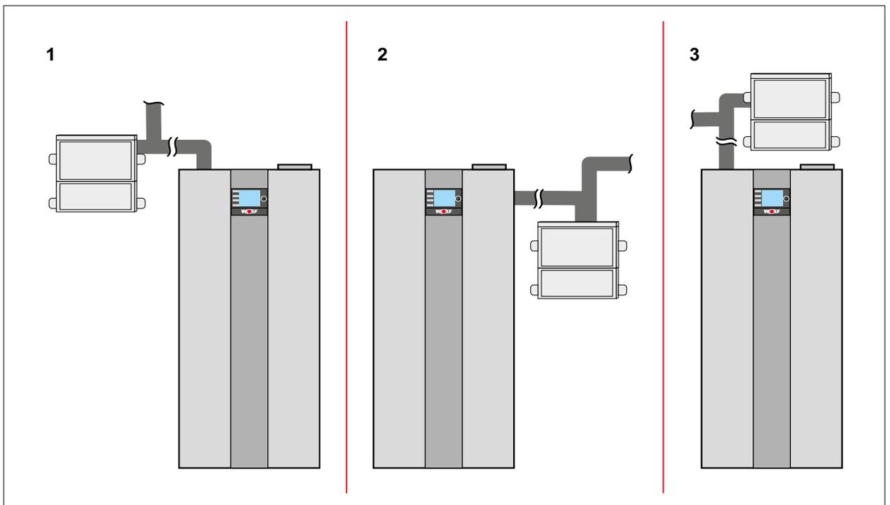
Abb. 5.20 Montagepositionen Elektroanschlusskasten an der Wand
