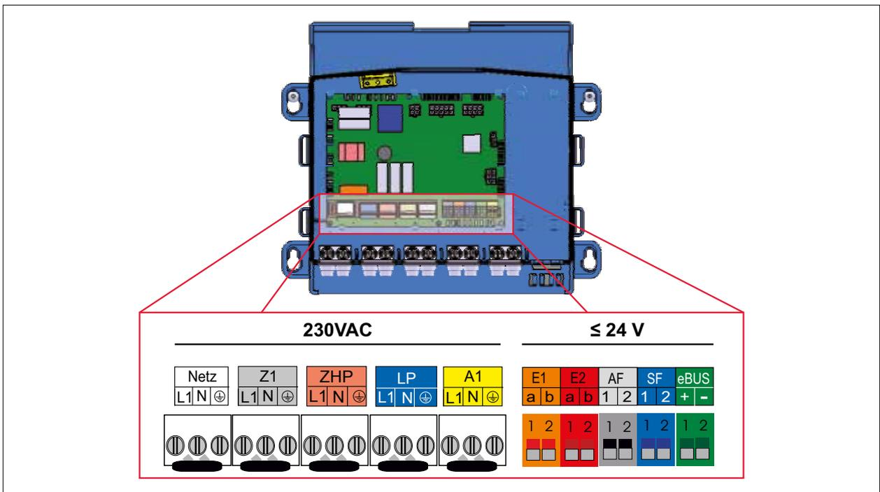
**Abb. 5.25 Klemmenbelegung Elektroanschlusskasten**
