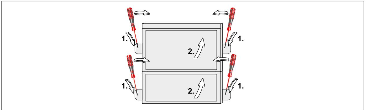
Abb. 5.19 Elektroanschlusskasten öffnen
