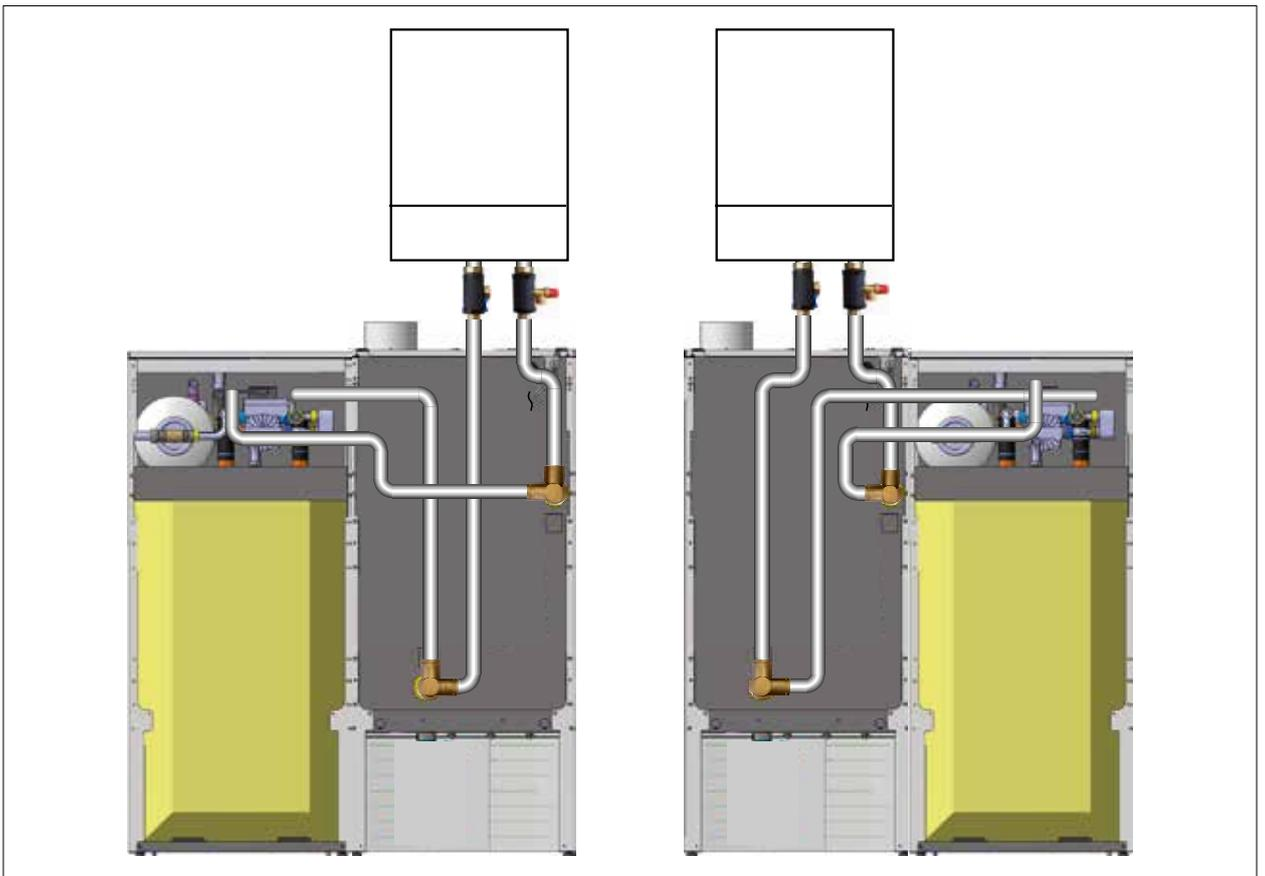
Abb. 5.8 Anschlussset hinter Wärmeerzeuger an der Wand
