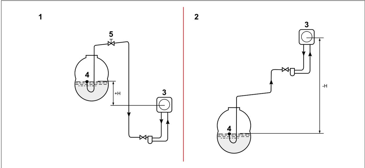
**Abb. 4.3 Schwimmende Absaugung**
