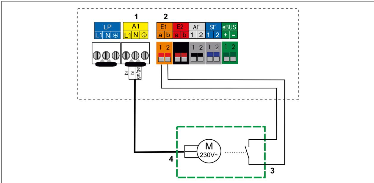
Abb. 12.3 Elektroanschluss Abgasklappe
