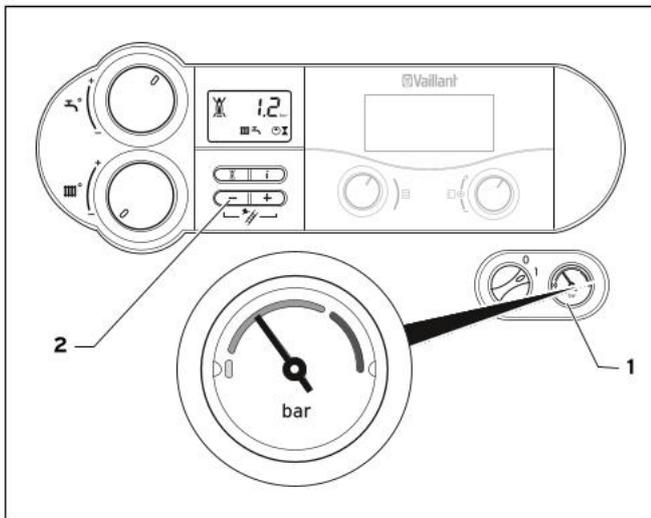
Abb. 5.17 Heizungsanlage füllen
