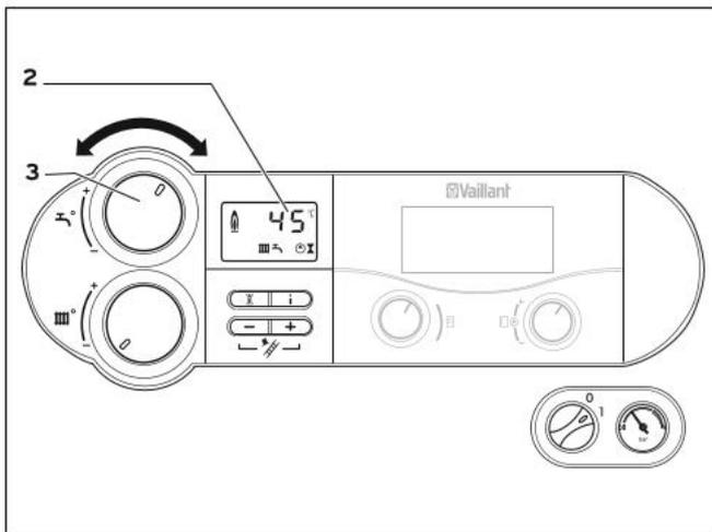
Abb. 5.6 Warmwassertemperatur einstellen
