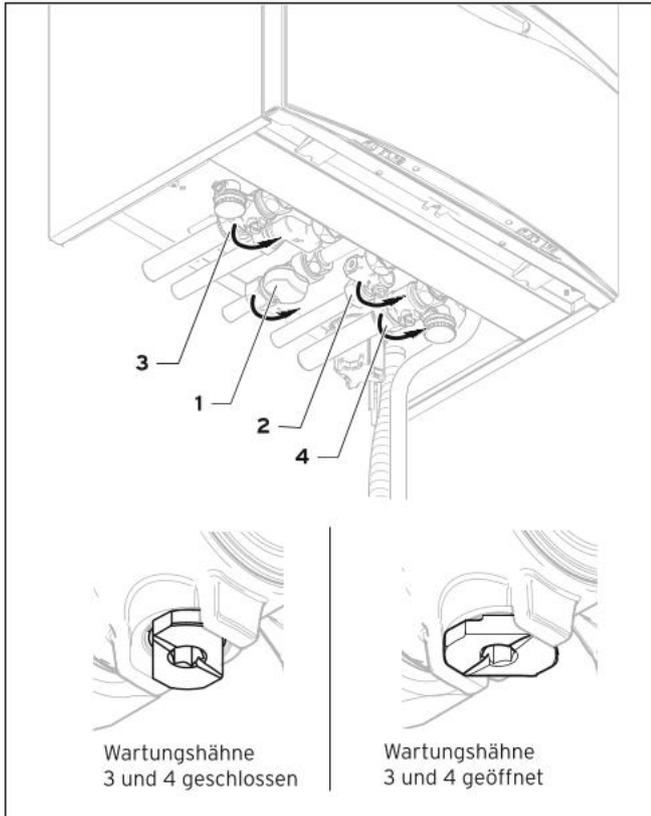
**Abb. 5.3 Absperreinrichtungen öffnen**
