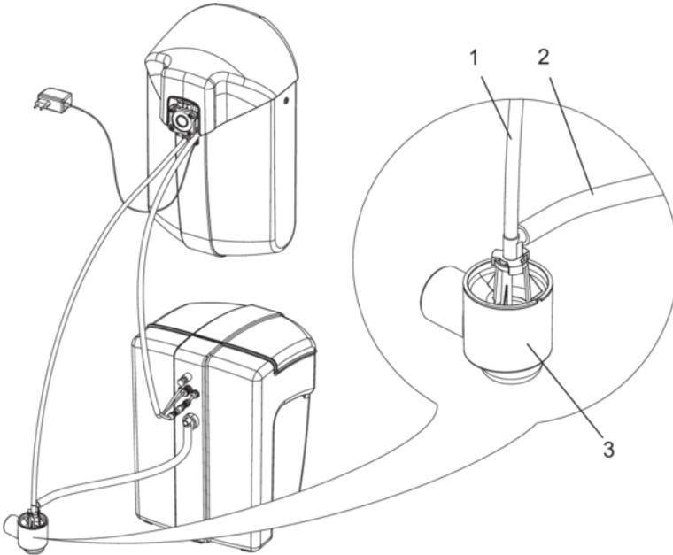
Abb. 7: Anschluss an Siphon
