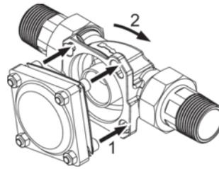
8. Das am Einbaudrehflansch hängende Gerät leicht **im** Uhrzeigersinn drehen, um die Schrauben in den Bohrungen des Einbaudrehflanschs einzurasten.
