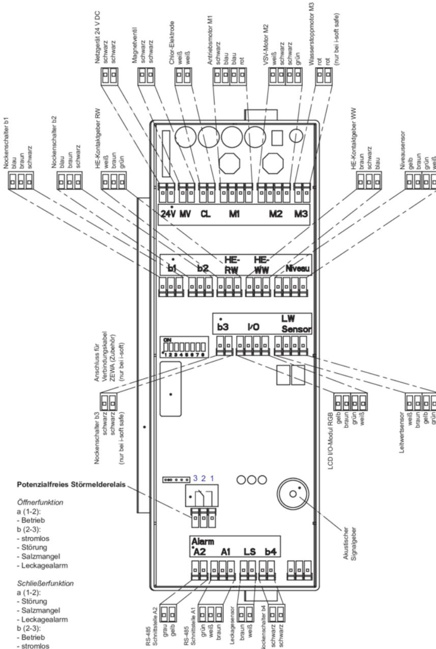
Abb. 12: Elektronische Steuerung mit Störmelderelais
