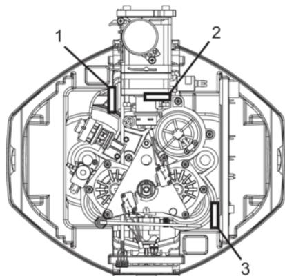
Abb. 8: Etikett Einbaudatum, Geräte- und Auftragsnummer
